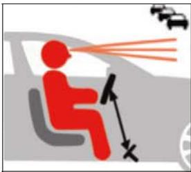
**Teilautomatisiertes Fahren:** Systeme dieser Stufe haben vollständigen Zugriff auf Gas, Bremse sowie Lenkung, doch der Fahrer muss sie jederzeit überstimmen können. Allerdings kann das Auto in vordefinierten Umgebungen, zum Beispiel der Autobahn, komplett übernehmen: Es kann einer Spur oder einem vorausfahrenden Auto
