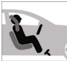
**Vollautomatisiertes Fahren:** Ab dieser Stufe kann der Autofahrer auf vordefinierten Strecken zum Passagier werden. Das Fahrzeug bildet selbst die sogenannte Rückfallebene: Sollten die Systeme ausfallen, kann das Auto eigenständig für einen sicheren Halt, etwa auf dem Seitenstreifen, sorgen. Der Mensch muss das Steuer
