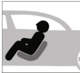
**Autonomes Fahren:** Diese Stufe entspricht der Idealvorstellung: Das Fahrzeug bewegt sich fahrerlos, trifft alle Entscheidungen selbst und kann überall unterwegs sein, unabhängig von Umfeldbedingungen und Straßentyp. Die Systeme meistern auch komplexe Verkehrssituationen, etwa an Kreuzungen, selbst bei fast jeder
