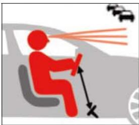
**Assistiertes Fahren:** Dem Fahrer stehen Assistenzsysteme zur Verfügung: Abstandstempomaten sorgen dafür, dass das Auto nicht zu dicht auffährt, Totwinkel-Assistenten leuchten im Seitenspiegel, andere Systeme halten das Auto in der Spur. Doch immer muss die Person am Steuer die Verkehrssituation selbst überwachen
